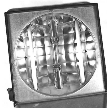
Eine ausgemusterte Höhensonne ermöglicht die Belichtung von Platinen in weniger als zwei Minuten.
